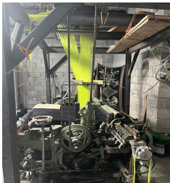
Figura 40. Montaje de sistema de transmisión de potencia por cadenas
