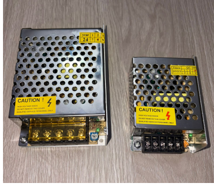
Figura 26: Fuentes de poder 24v y 12v. Nota. Imagen Tomada de autoría propia.
