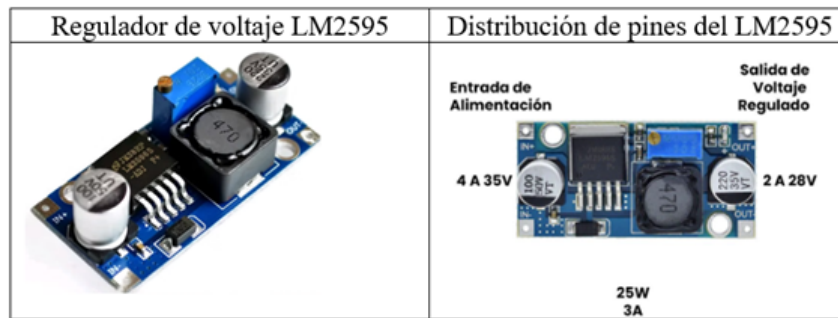
Figura 24: Módulo Regulador de Voltaje LM2595 y Distribución de sus Pines Nota. Imagen Tomada de (ELECTRONICS, 2020)
