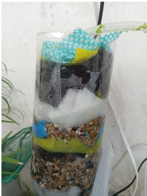
Ilustración 3 Nuñez & Tenezaca filtro casero compuesto filtrando
