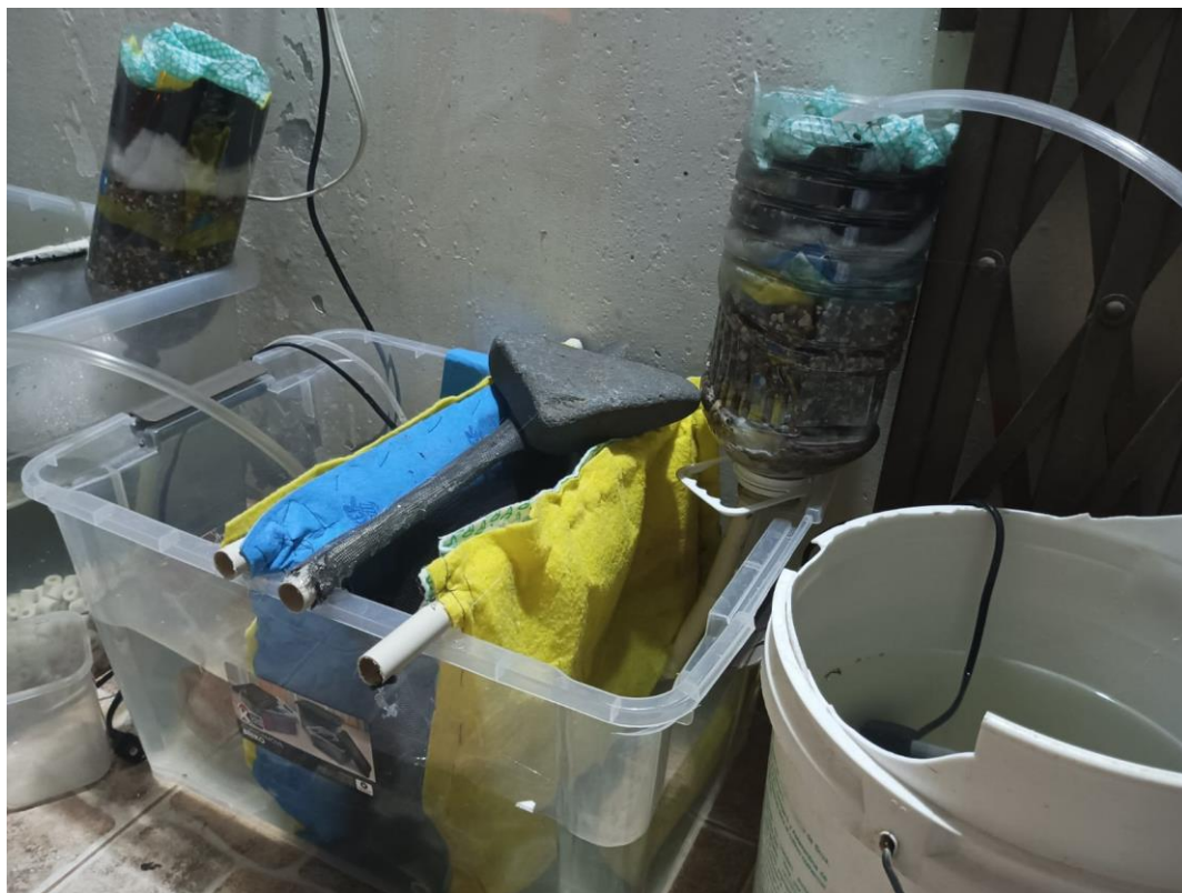
Fuente: 5 Autores Núñez & Tenezaca Filtro artesanal entre Tanque 2 y 3. Se utilizó un envase plástico transparente relleno con capas
