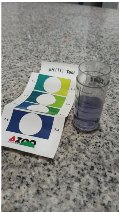
Ilustración 7 Nuñez & Tenezaca Medición de pH previos a los realizados en laboratorio
