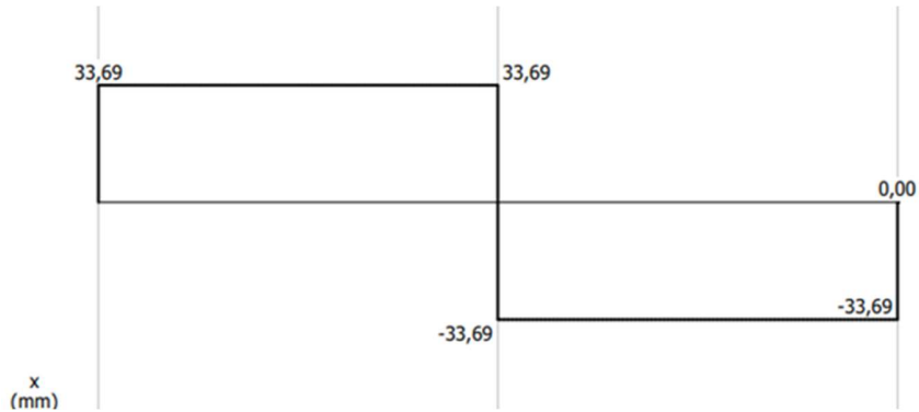
Figura 23. Diagrama de fuerzas cortantes.
