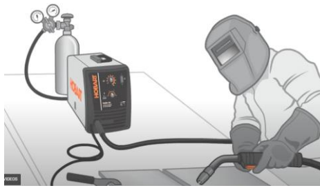
Figura 14. Representación sistema de soldadura MIG [31]
