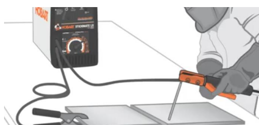
Figura 13. Representación sistema de soldadura SMAW [31]
