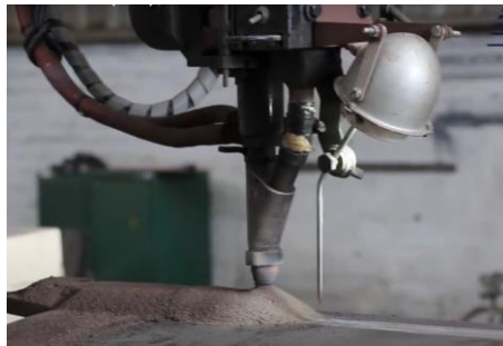
Figura 15. Representación sistema de soldadura por arco sumergido [32]
