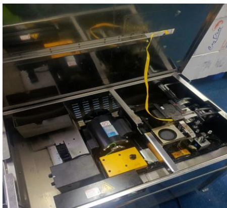
Figura 12. Máquina enzunchadora (parte interna)
