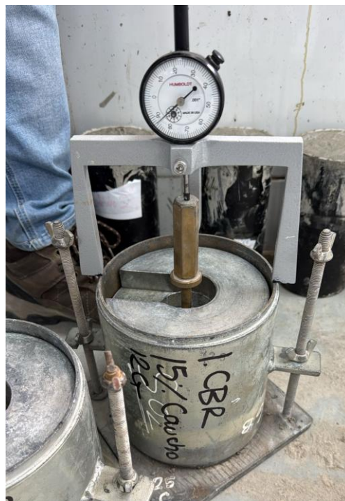
Ilustración 51. Toma de muestras de hinchamiento
