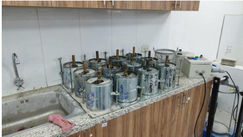
Ilustración 42. Realización de los CBRs
