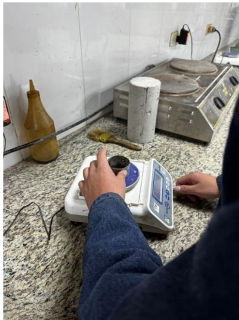
Ilustración 47. Toma de pesos para humedades
