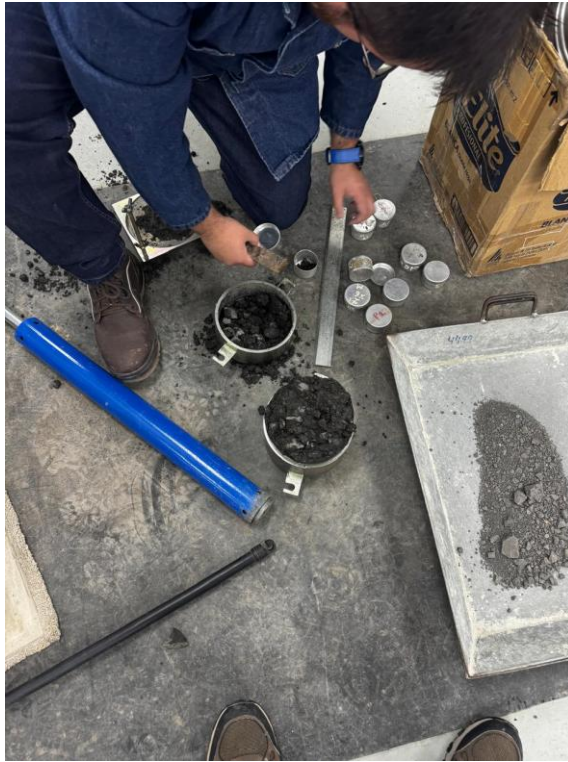
Ilustración 38. Toma de muestras de humedades
