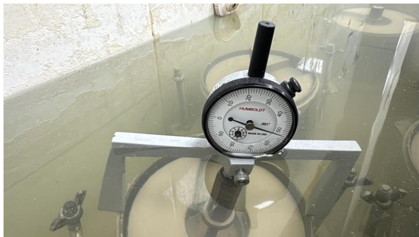
Ilustración 41. Toma de muestras de hinchamiento en el día
