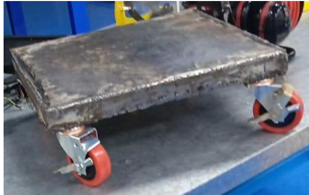
Implementación de la plancha de acero y de ruedas industriales
