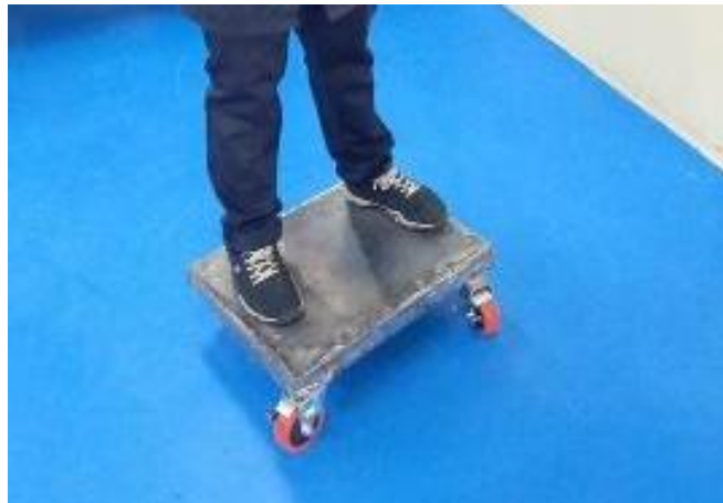
Comprobación de la estabilidad y desplazamiento del banco de carga
