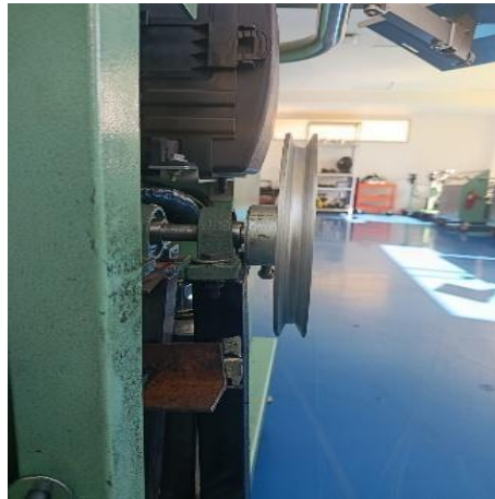
Polea instalada en la junta homocinética de la transmisión
