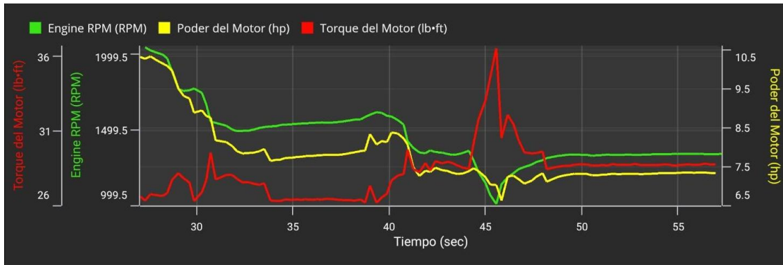
Comportamiento del motor bajo carga
