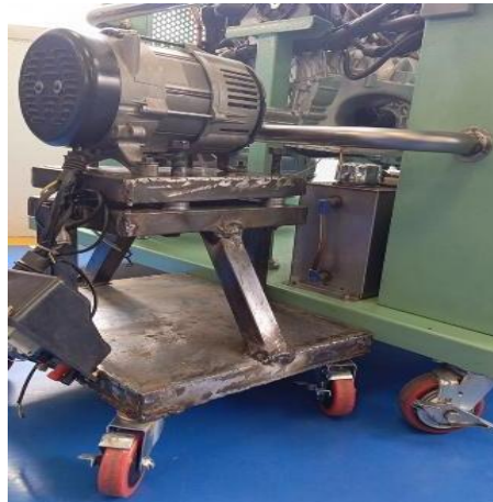
Ensamblaje del banco de carga y el motor de combustión interna
