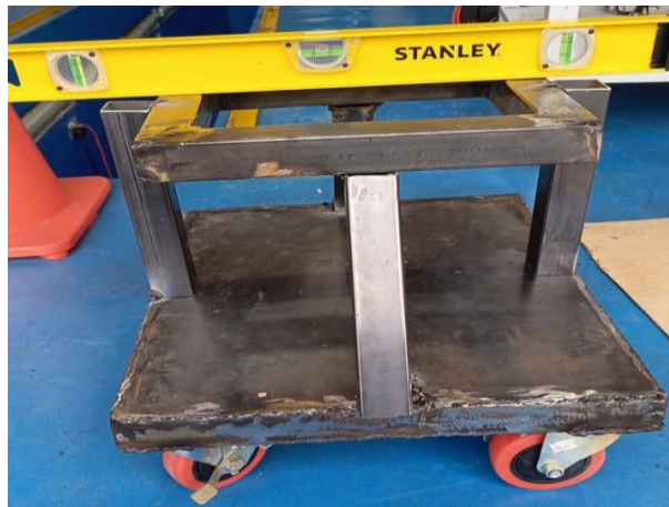
Ensamblaje de la base del generador y la base del banco de carga
