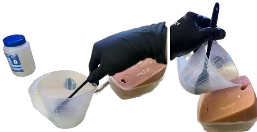
(a) Mezcla final de los componentes A y B (b) Vertido final en el molde
