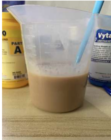
Figura 35: Mezcla de los componentes A y B de VytaFlex 40
