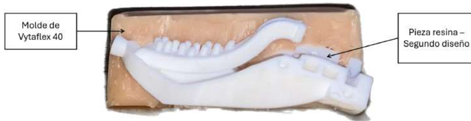
Figura 73: Pieza de silicona NV10 obtenida con el molde de VytaFlex 40 del segundo diseño.
