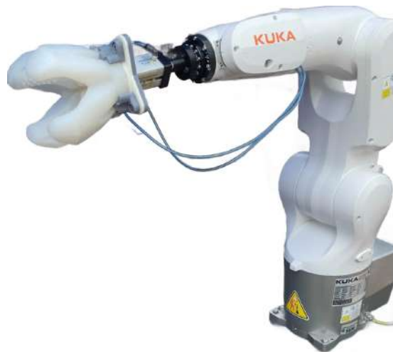
Figura 62: Acoplamiento del gripper a la base adaptadora según el diseño previsto.
