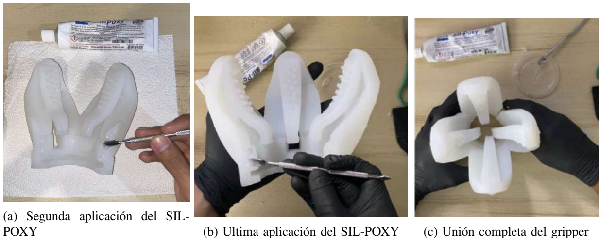
Figura 53: Aplicación de adhesivo SIL-POXY para la unión de piezas de silicona
