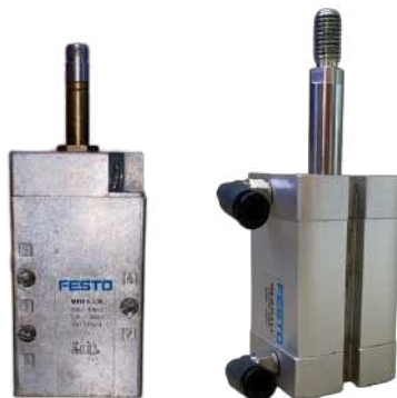
Figura 63: Elementos neumáticos principales y conexión al pistón
