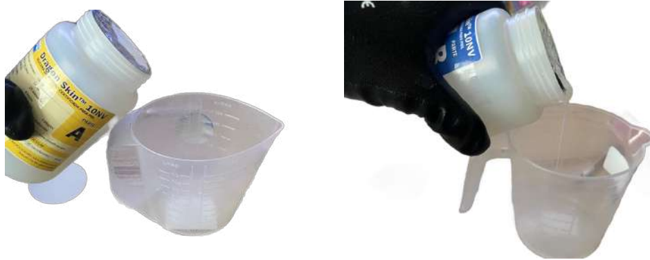
(a) Vertido de silicona Vytaflex – Parte A (b) Vertido de silicona Vytaflex – Parte B
