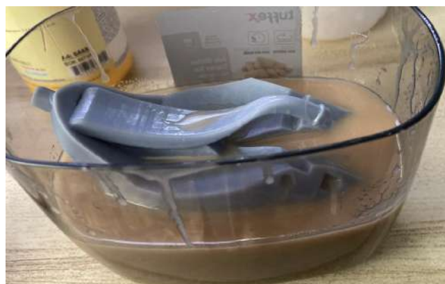
Figura 36: Vertido de la mezcla de VytaFlex 40
