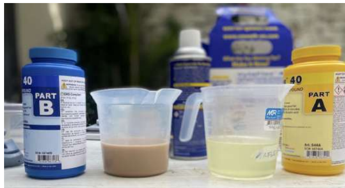
Figura 46: Componentes A y B del caucho Vytaflex 40 - Segundo Diseño
