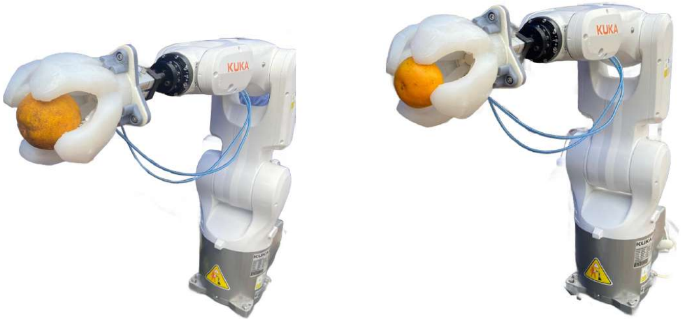
(a) Manipulación de una naranja con el gripper neumático.
