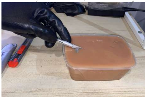
(c) Corte preciso del exceso de material con estilete de precisión
