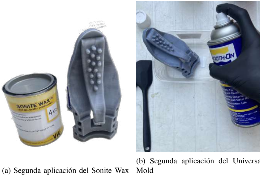
Figura 45: Aplicación de desmoldantes del Segundo Diseño
