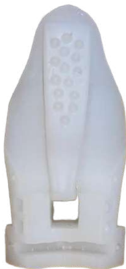
Figura 50: Pieza de silicona del segundo diseño desmoldada del molde de Vytaflex.
