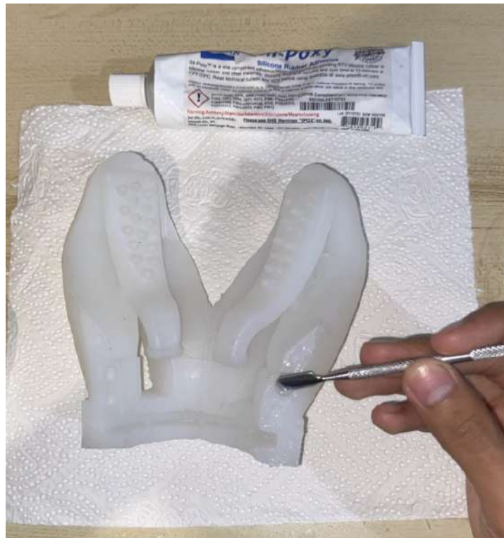
Figura 52: Primera unión de las dos secciones del gripper.
