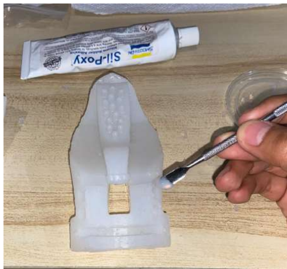
Figura 51: Primera aplicación del SIL-POXY.
