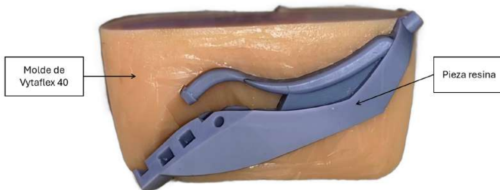
Figura 37: Molde de VytaFlex 40 partido a la mitad, mostrando la pieza vertida en su interior.
