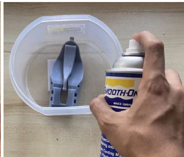
(b) Aplicación de UNIVERSAL MOLD RELEASE
