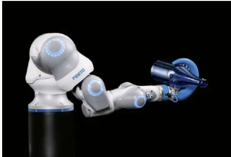
Figura 2: Tentacle Gripper de FESTO) [23].
