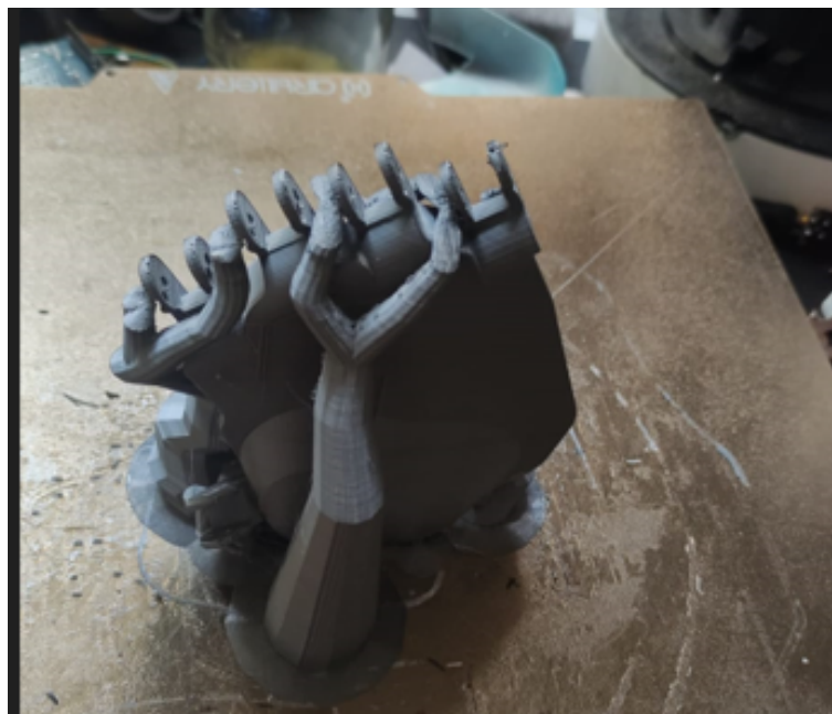
Figura 12. Pieza impresa por filamento en PETG. Elaborado por autores.
