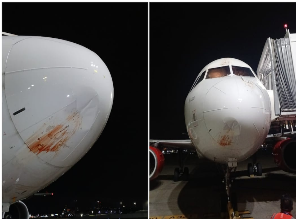
Figura 2: Daño en el avión después de la colisión [34].
