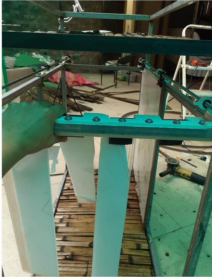
Figura 18: Sistema de bisagras - Foto 2 [40].
