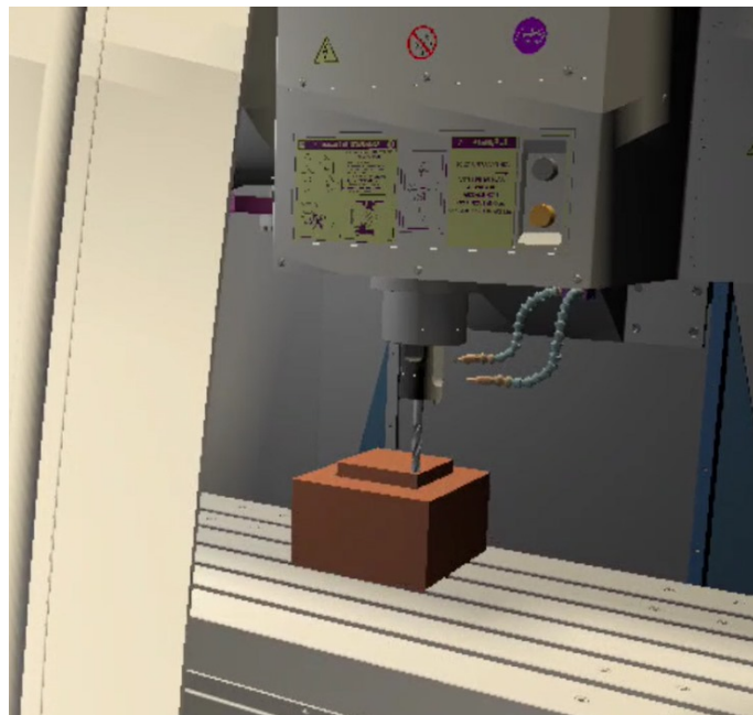
Figura 33. Proceso de mecanizado con herramienta de desbaste
