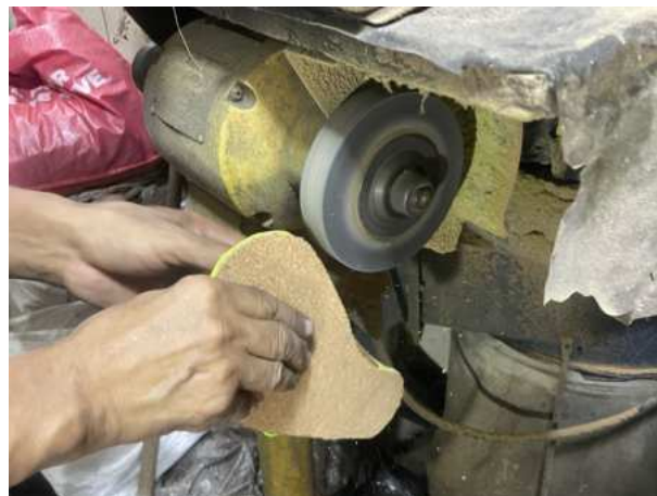
Figura 12: Lijado de los detalles de la plantilla, Elaborado por autor
