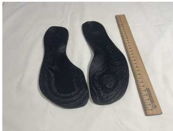
Figura 54: Diseño de plantilla de TPU con hendidura para el docente 1, elaborado por autor
