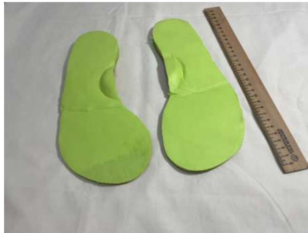
Figura 47: Diseño de plantilla de goma EVA con Relleno para el docente 1, elaborado por Autor
