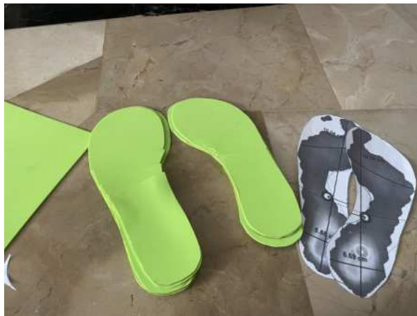
Figura 10: Recorte de la goma EVA capa por capa, Elaborado por autor
