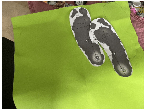
Figura 74: Recorte de capas en Láminas EVA para la fabricación de la plantilla de goma EVA, elaborado por Autor
