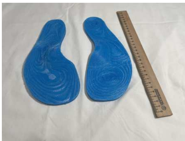
Figura 57: Diseño de plantilla de TPU con relleno para el docente 3, elaborado por autor
