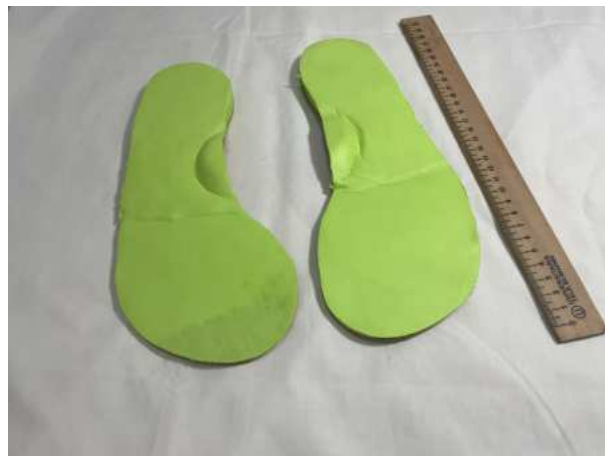
Figura 48: Diseño de plantilla de goma EVA con hendidura para el docente 1, elaborado por autor
