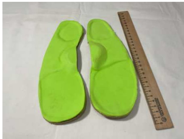
Figura 50: Diseño de plantilla de goma EVA con hendidura para el docente 2, elaborado por autor
