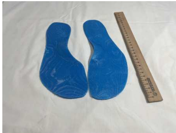
Figura 53: Diseño de plantilla de TPU con relleno para el docente 1, elaborado por autor
