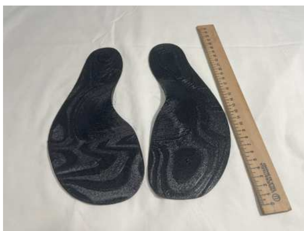
Figura 58: Diseño de plantilla de TPU con hendidura para el docente 3, elaborado por autor
