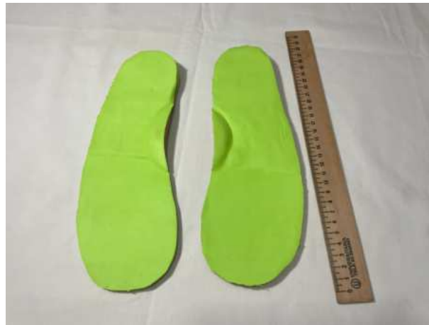
Figura 49: Diseño de plantilla de goma EVA con Relleno para el docente 2, elaborado por Autor
