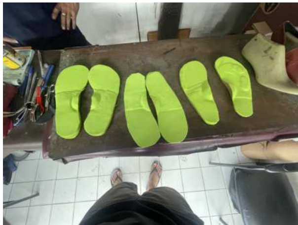
Figura 77: Plantillas antes de pasar al proceso de lijado, Elaborado por Autor
