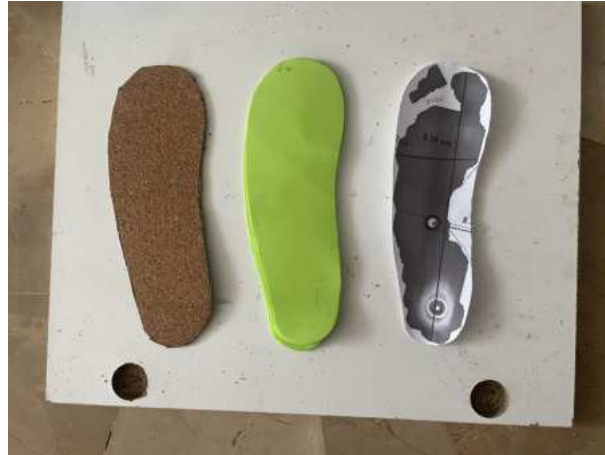
Figura 11: Integración de la capa de corcho como base y arco, Elaborado por autor
