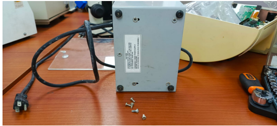
Figura 12. Quitar tornillo en la parte inferior
