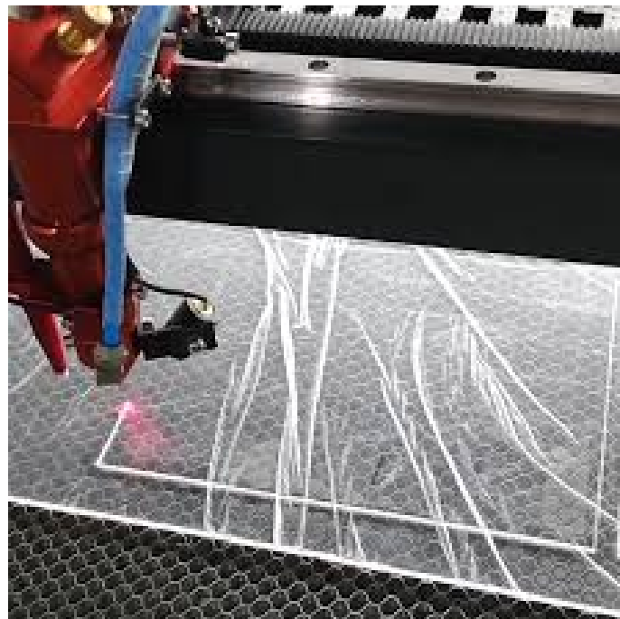
Figura 15. Impresión de tapa en una cortadora láser
