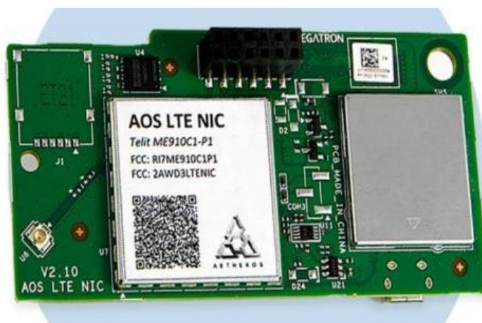
Figura 19. Dispositivo IoT: tarjeta NIC AOS LTE Fuente: Tomado de [43]
