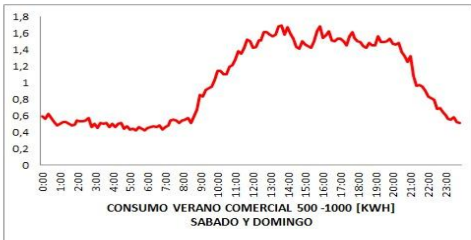
Figura 32. Curva Normalizada Comercial Días Semi - Hábiles transformador 2 Fuente: Elaborado por los autores
