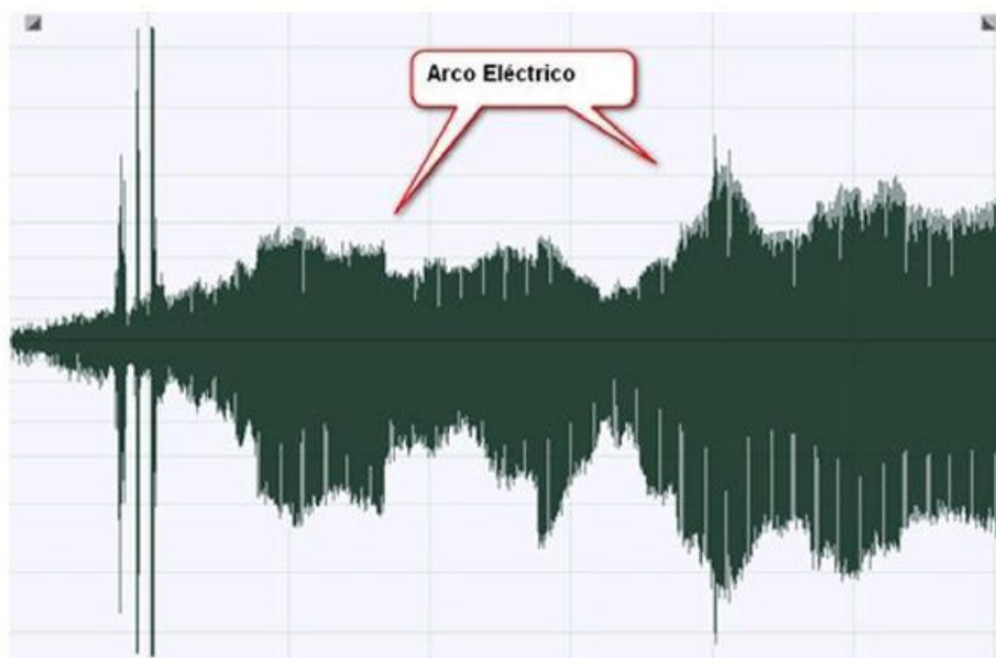
Figura 29. Ultrasonido en cadena de aisladores de 69 k Fuente: Anexo 2
