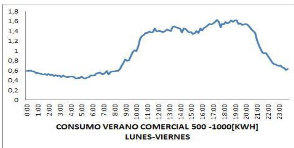
Figura 31. Curva Normalizada Comercial Días Hábiles Transformador 1
