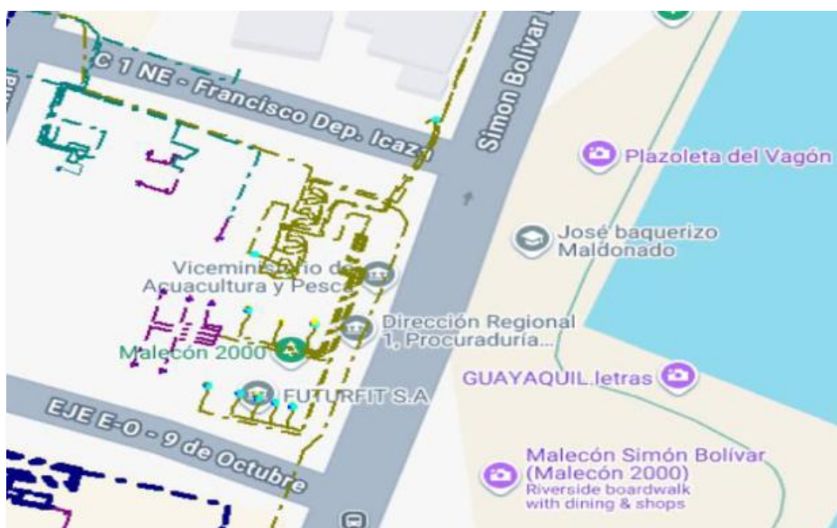
Figura 54. Localización del sector de mayor Densidad de Carga: Alimentadora Malecón software CYMDIST Fuente: Elaborado por los autores
