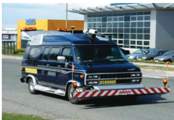
Figura 1. Vehículo para la identificación fallas
