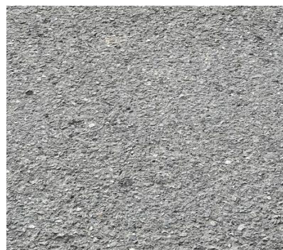
Figura 19. Pulimento del agregado
