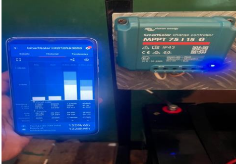
Fig. 4 Controlador Victron SmartSolar MPPT 75/15 instalado en La Masa 2.
