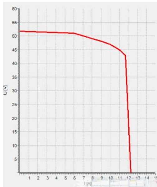
Ilustración 38. Curva de 1000\text{W/m}^2 Fuente: Simulación view de ATP-DRAW
