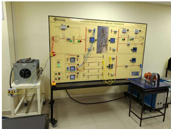
Figura 20. Circuito de línea media Fuente: Autores
