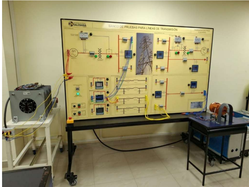
Figura 21. Circuito de línea larga Fuente: Autores
