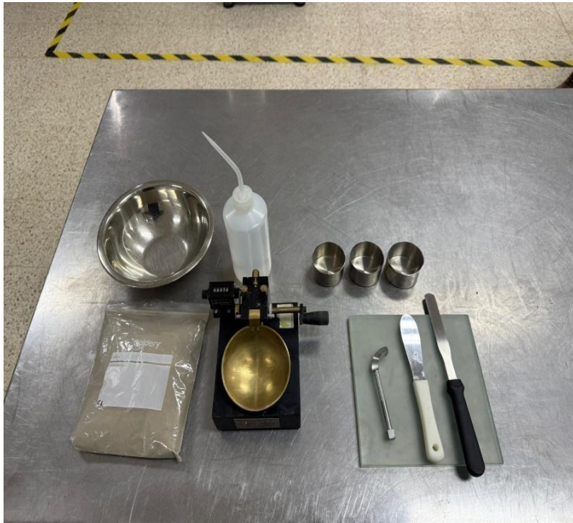
Ilustración 25. Equipos para Ensayo Límites de Atterberg.
