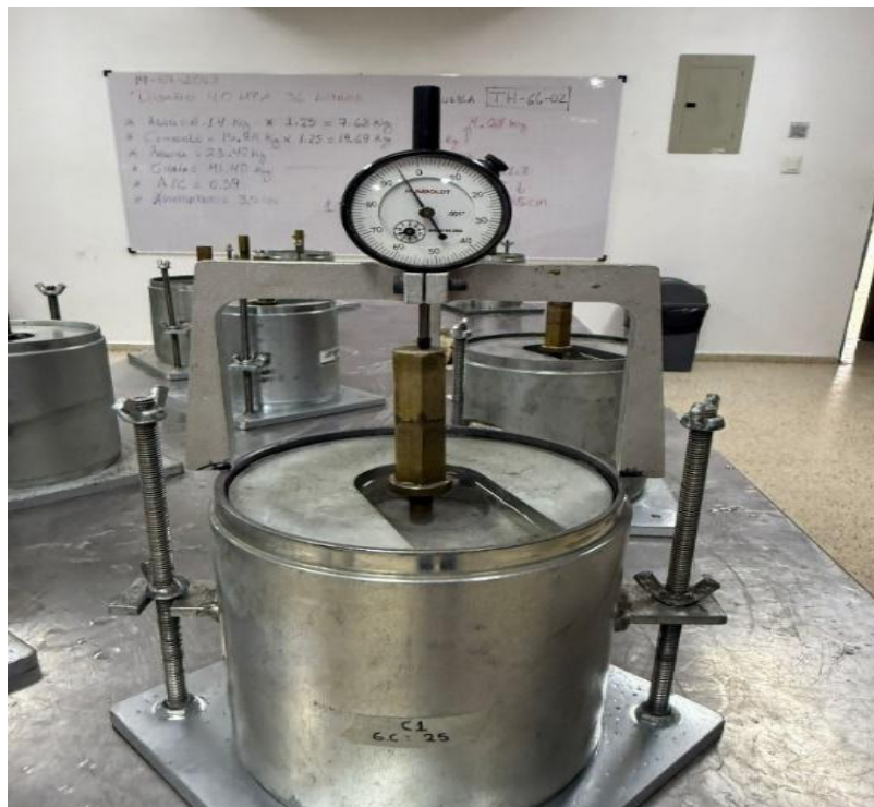
Ilustración 36. Colocación de Peso.
