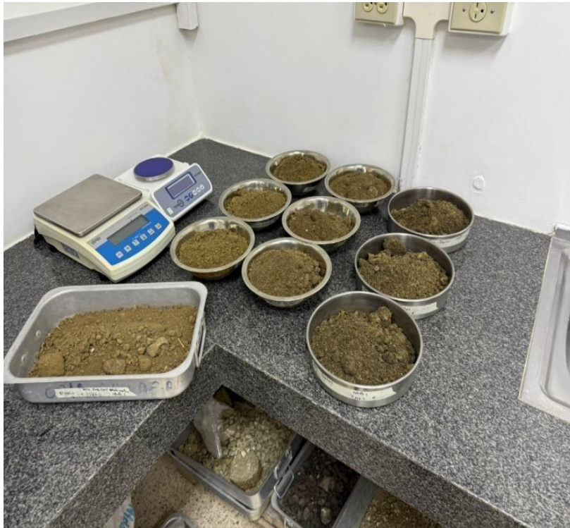
Ilustración 34.Muestra de Calicata 1 ,2 ,3 para Llevar a Horno.
