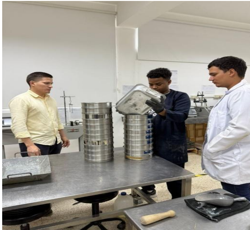
Ilustración 24.Ensayo de granulometría – Por tamizado.
