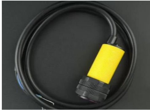
Figura 15. Sensor infrarrojo E18-D80NK [19].
