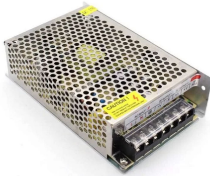
Figura 46. Fuente de Alimentación 24V a 20A, [59].
