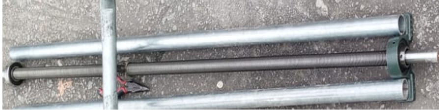
Figura 73. Tornillo sin fin y chumaceras.
