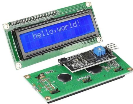
Figura 44. Pantalla LCD 1602 con I2C Arduino, [57].
