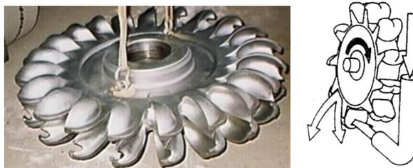
*Figura 1.10 Turbina de Acción.*
