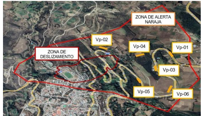
Figura 2. Ubicación de líneas de refracción sísmica [2]
