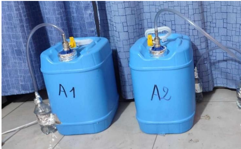
Figura 10. Ensamblaje de los biodigestores
