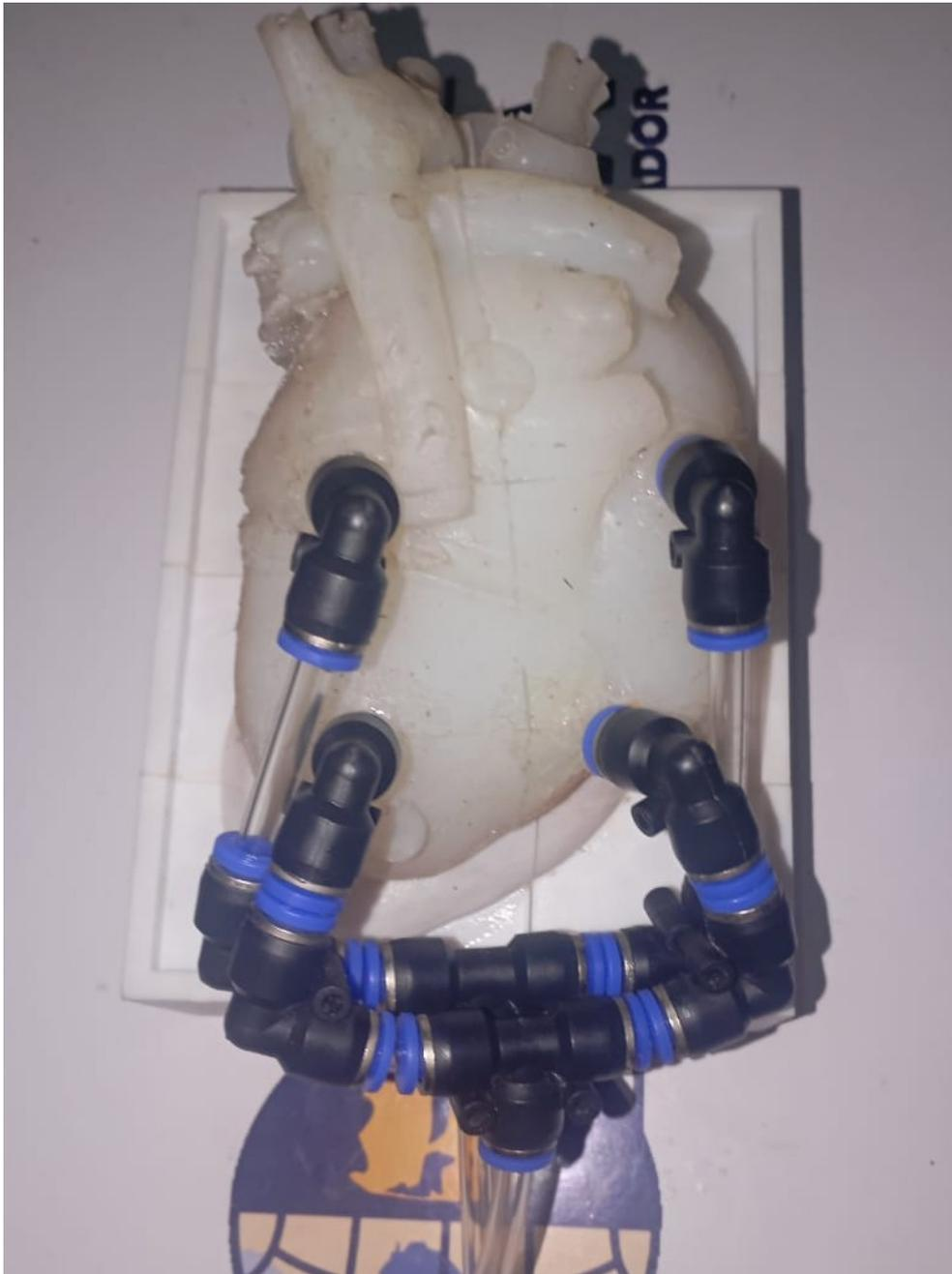
Figura 48. Corazón con conectores neumáticos
