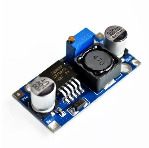
Figura 28. Regulador de voltaje DC/DC Step Down LM2596
