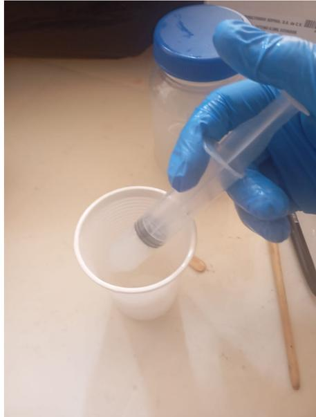
Figura 21. Preparación de la Mezcla de Silicona
