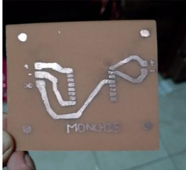
Figura 3.20: Finalización del Proceso de Preparación de la PCB
