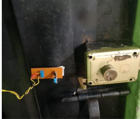
Figura 4.6: Sensor de Vibración Colocado en la puerta de una Vivienda
