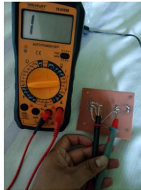
Figura 3.21: Inspección de Continuidad y Conexiones con Multímetro
