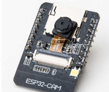
Figura 3.1: Dispositivo ESP32-CAM, Fuente: (HackSpace, 2024)
