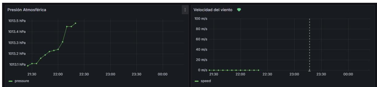
*Nota. Dashboard muestra datos en tiempo real de sensores de presión atmosférica y velocidad el viento*
