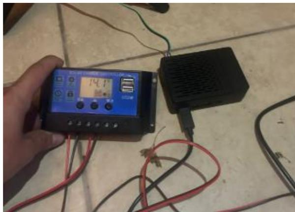
*Nota. Administra y regula el flujo de energía a través de una batería y del panel solar*
