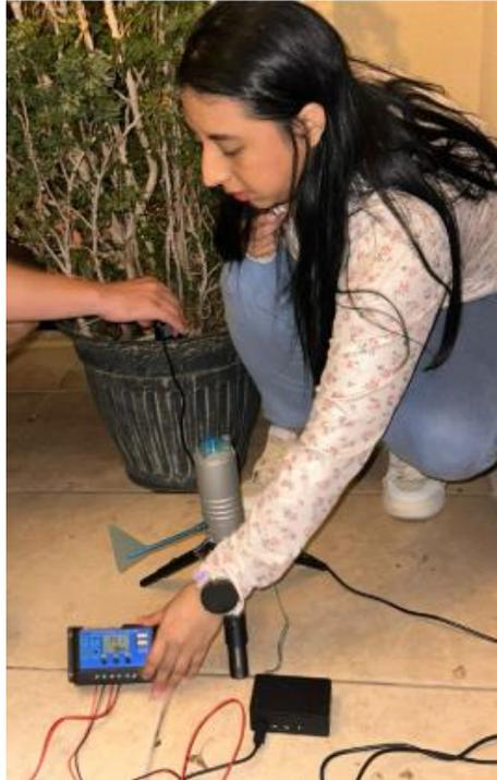
*Nota.* Conexión de la Raspberry pi4 a la estación meteorológica LARK
