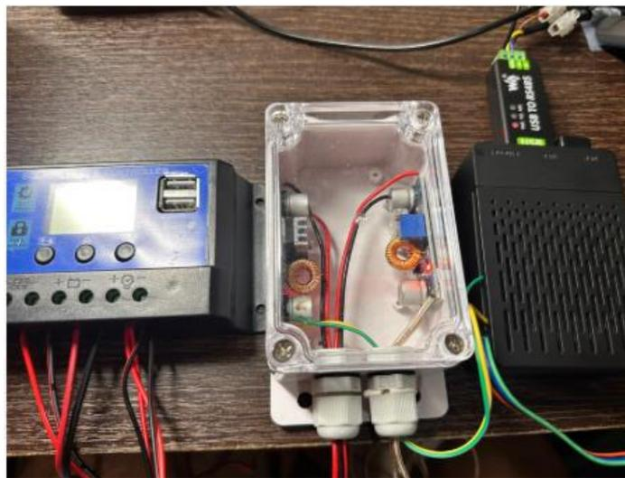
Nota. Conexión del PWM a los reguladores de voltaje a la Raspberry Pi 4
