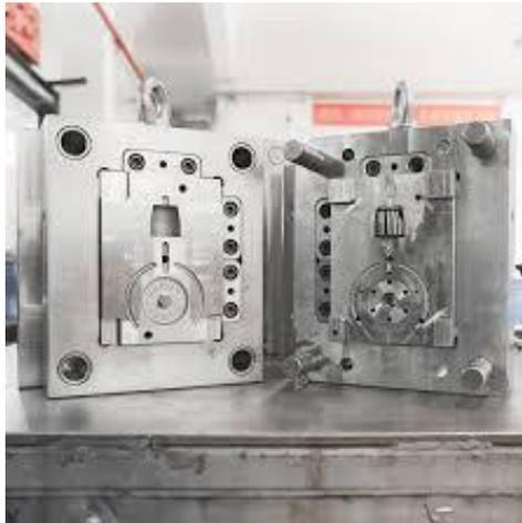
*Figura 7.* Molde de una sola cavidad
