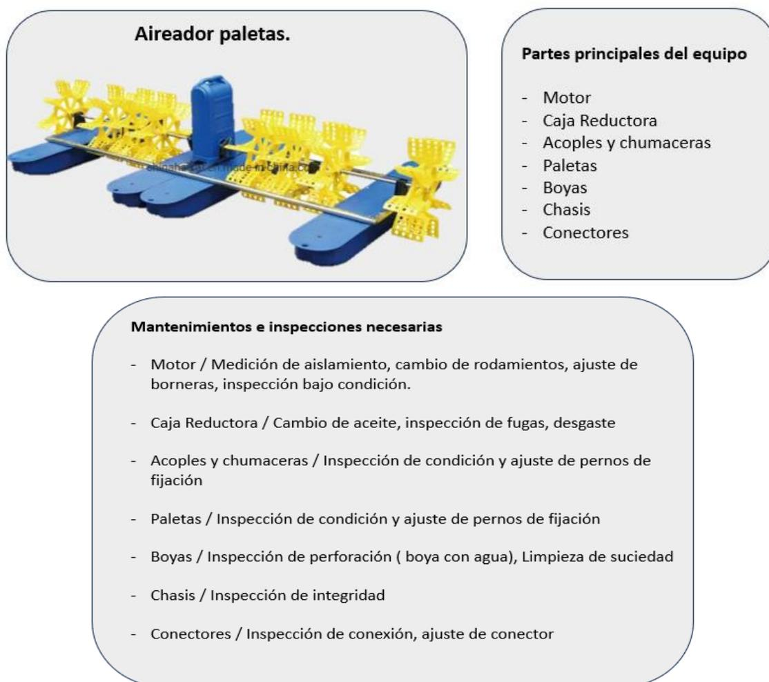
*Nota: La imagen muestra a un aireador eléctrico de 8 paletas usado en los procesos de aireación de piscinas de camarón, así como sus partes principales y sus rutinas básicas para el mantenimiento.*
