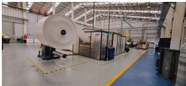
*Figura 13. Demarcación de la zona segura de la máquina*
