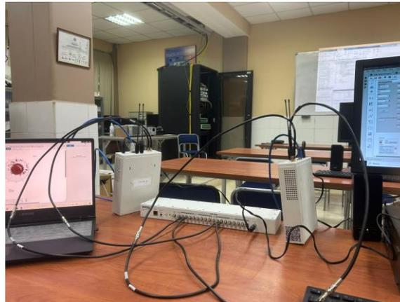
Figura 3.1: Montaje experimental del sistema OTFS en laboratorio. Fuente: Elaboración propia.
