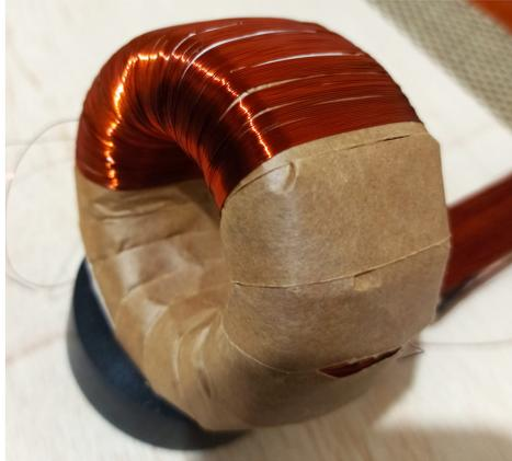
Figura 14: Bobinado del devanado primario en núcleo de ferrita FeSi.
