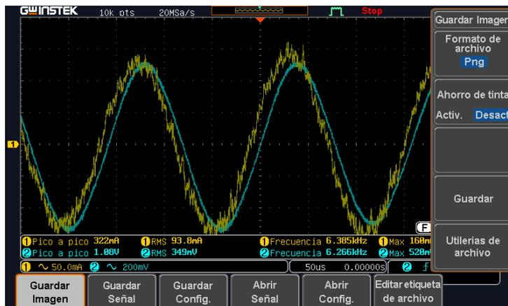
Figura 28: Medición voltaje y corriente a 6.3kHz.
