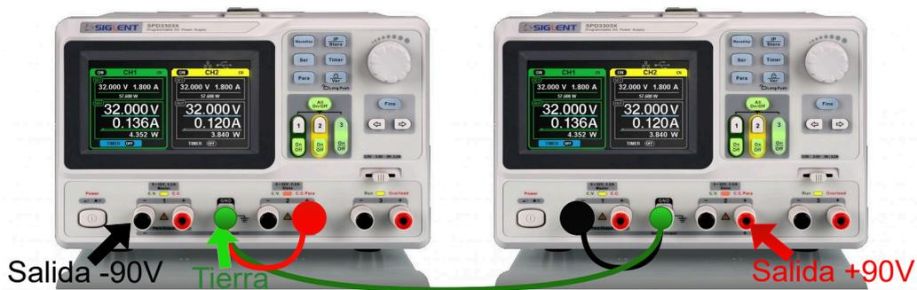
Figura 20: Conexión en serie de fuentes DC.
