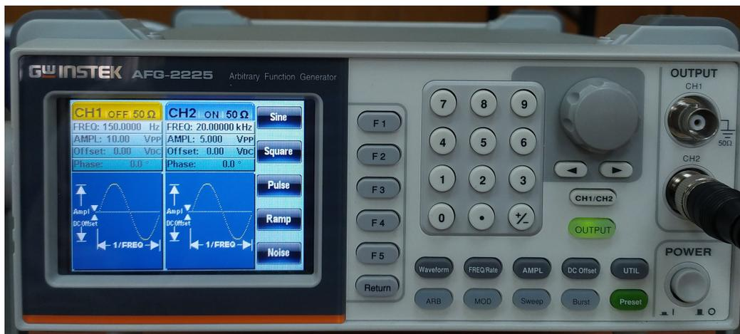
Figura 22: Set inicial del generador de funciones.
