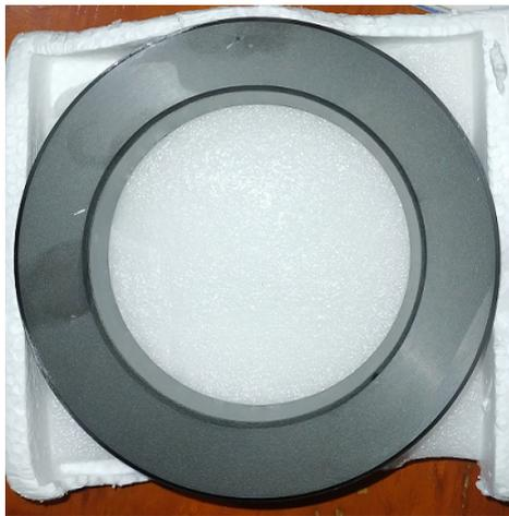
Figura 15: Núcleo de Ferrita MnZn.
