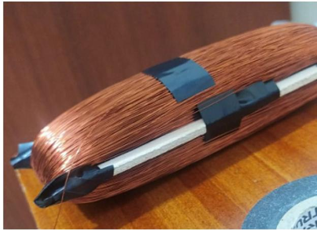
Figura 17: Lanzadera con el alambre del devanado secundario.
