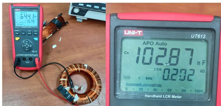
Figura 33: Medición de inductancia y capacitancia en serie.
