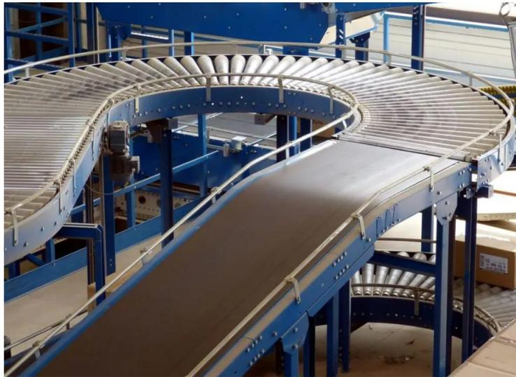
**Nota:** En la figura se aprecia la banda transportadora con rodillos y cintas, de acuerdo a Yuridia (2021).
