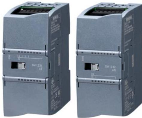
**Nota:** En la imagen se puede apreciar la estructura de los módulos de expansión tanto como entradas y salidas analógicas, de acuerdo a . *Módulo de salidas y entradas analógicas SM 1232 (2025)*
