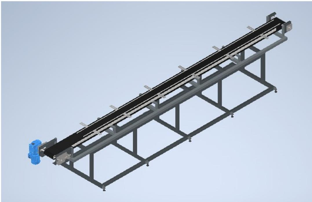
**Nota:** La siguiente imagen nos muestra la estructura final de la banda transportadora.
