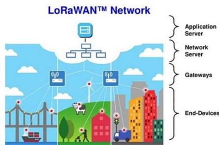
Figura 5: Arquitectura de una red LoraWan [27].
