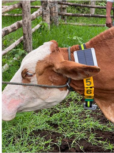
Figura 46: Instalación del sistema en el ganado [Fuente: Autores].
