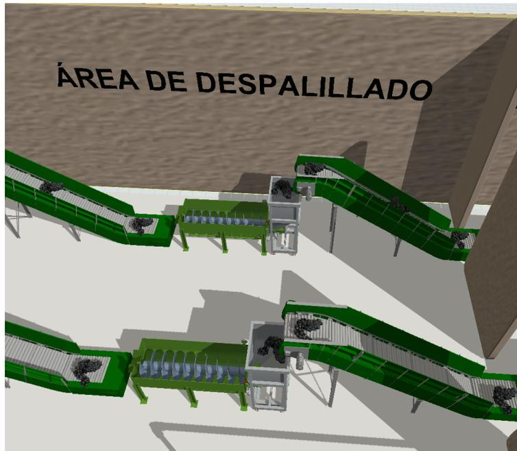
Figura 11. Proceso de Separación de Uvas y Tallos
