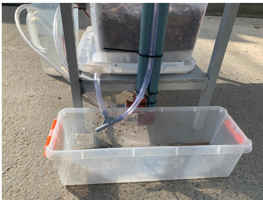
Figura 37. Red de Tubería para Desagüe en los Contenedores Plásticos. Fuente: Los Autores.
