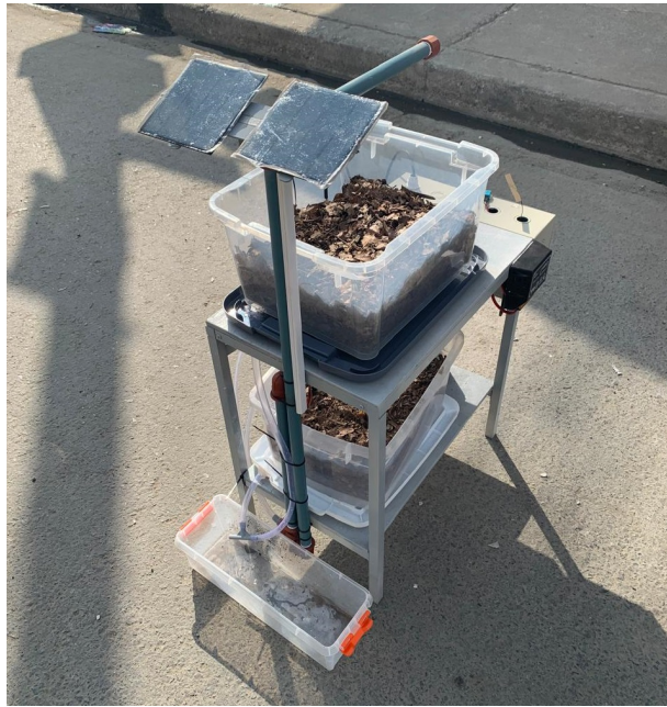
Figura 39. Prueba de los Nodos LoRa en Zona Aislada. Fuente: Los Autores.
