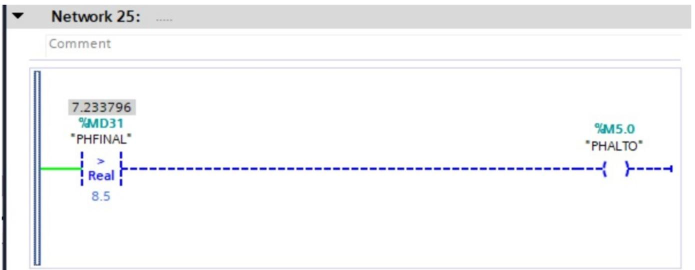
Figura 43: Verificación del PH en estado bajo: P. Castro
