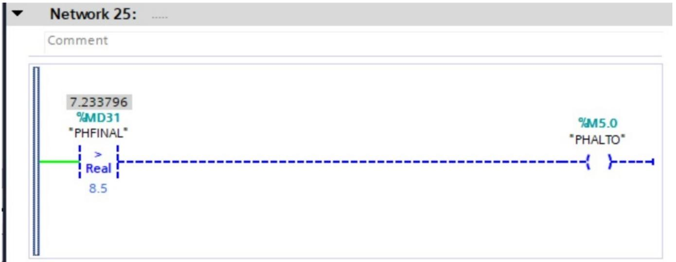
Figura 42: Verificación del PH en estado alto: P. Castro
