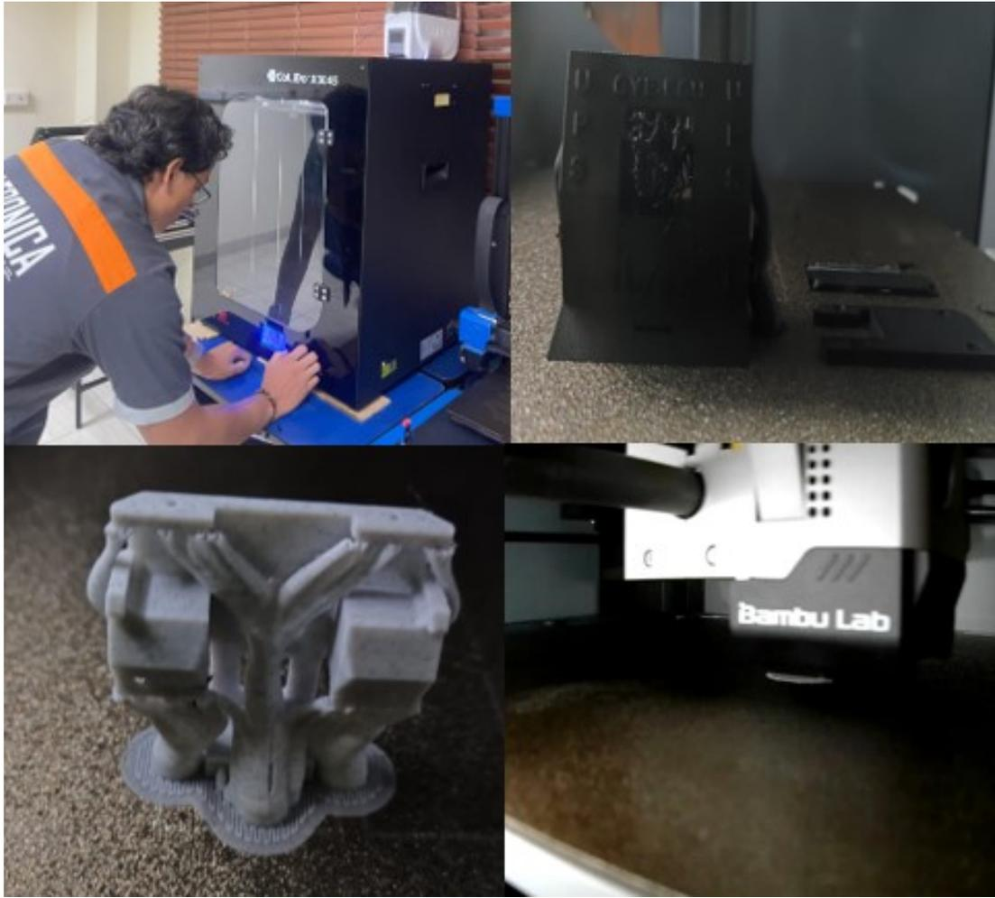
Ajuste y calibración de la impresora 3D para la fabricación de las piezas del robot micro sumo. Se utilizó soporte tipo árbol para mejorar la estabilidad y calidad de la impresión, asegurando un acabado preciso y funcional. Fuente: D. Guevara.
