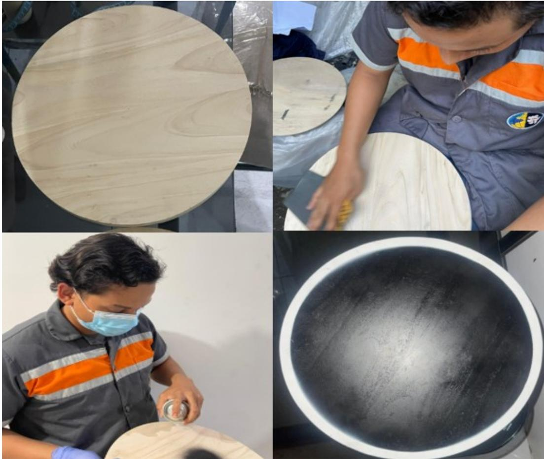
El dohyo fue fabricado siguiendo las medidas oficiales del reglamento para la categoría micro sumo, garantizando un área de combate precisa. Se aplicó la pintura adecuada para mejorar la visibilidad y se finalizó con un acabado mate, asegurando una superficie óptima para el desempeño de los robots en combate. Fuente: D. Guevara.
