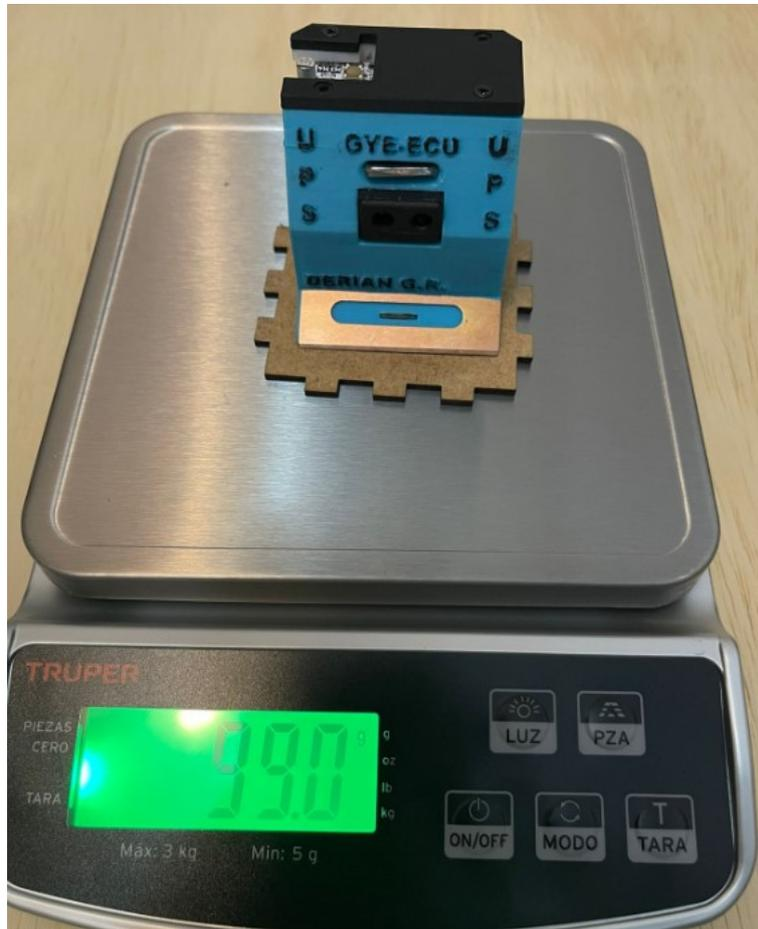
Figura 21. Peso de 99.0g Robot Micro Sumo pesado. por D. Guevara.
