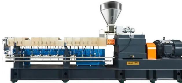
Figura 3. Extrusora de doble tornillo [28].
