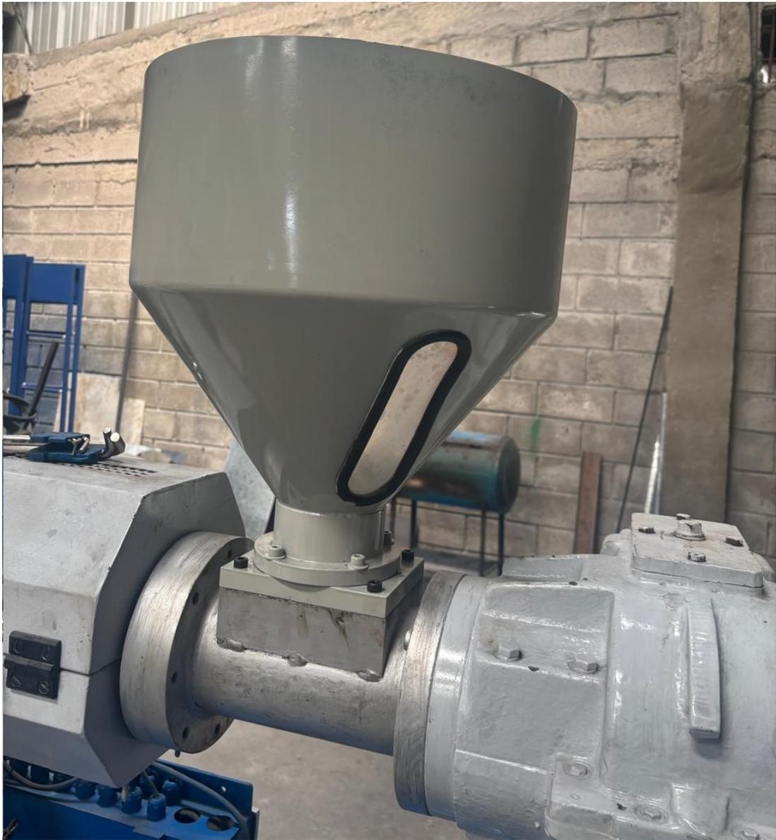
Figura 47. Acople de la tolva a la máquina extrusora, por A. Pico y I. De La Puente.
