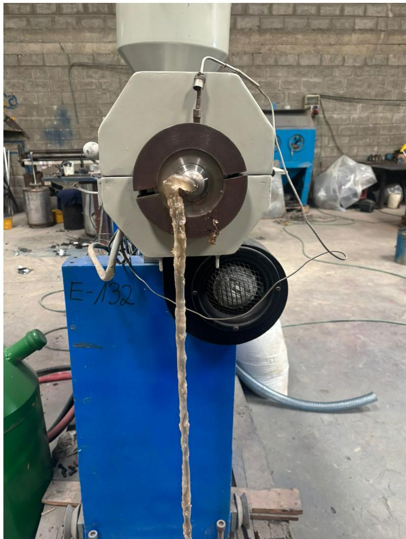
Figura 39. Máquina extrusora en funcionamiento, por A. Pico y I. De La Puente.
