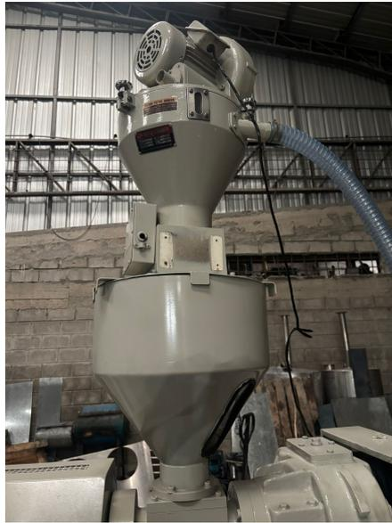
Figura 34. Ensamble de Blower, Tolva y Tablero, por A. Pico y I. De La Puente.
