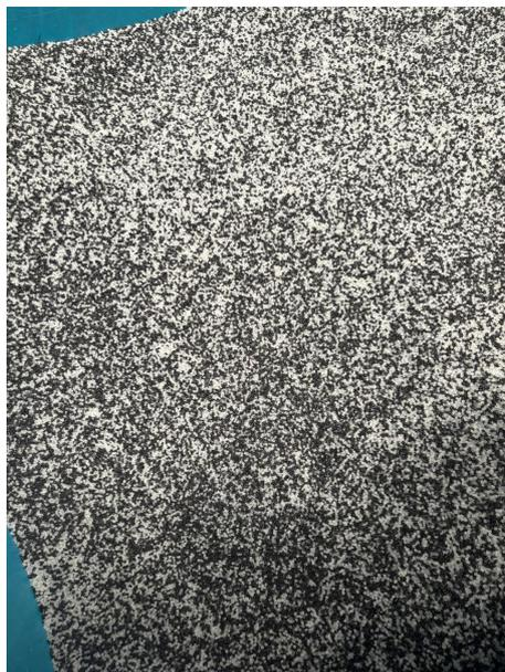
Figura 40. Mezcla de materia PE con pigmento de color, por A. Pico y I. De La Puente.
