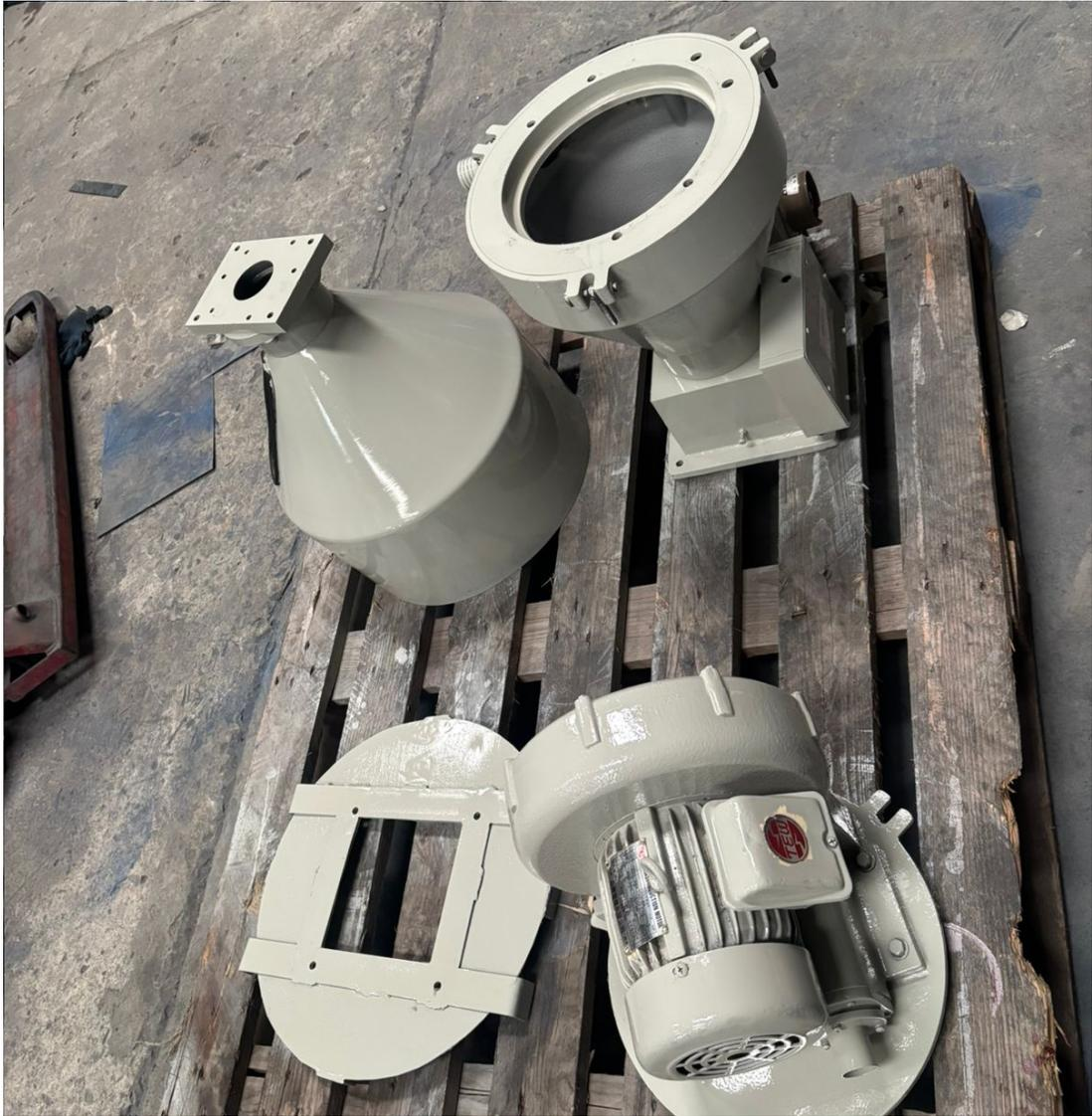
Figura 46. Componentes esenciales para ensamblar a la máquina extrusora, por A. Pico y I. De La Puente.
