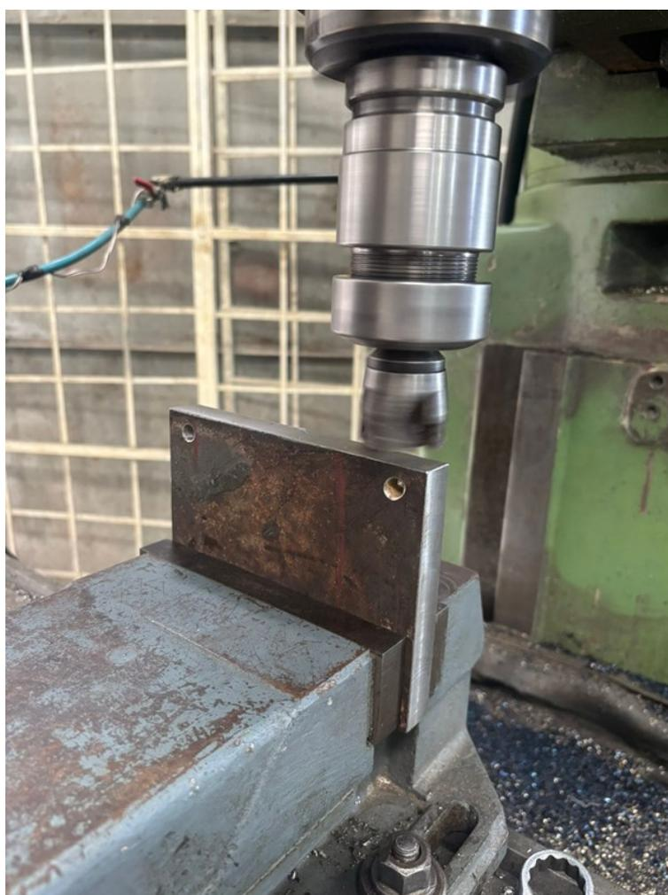
Figura 43. Corte de la placa para la tolva, por A. Pico y I. De La Puente.
