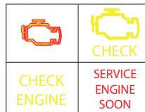
Figura 4.6. Diferentes tipos de luz indicadora MIL→ (Malfunction Indicator Light)
