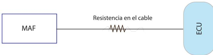
Figura 4.28. Resistencia por cable en mal estado
