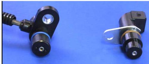
Figura 4.2. Distintos tipos de sensores CKP
