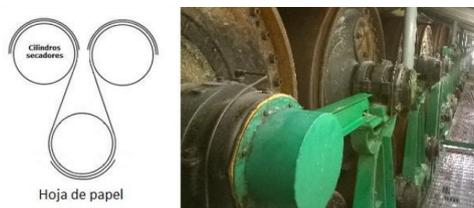
Figura 15. Sección de cilindros metálicos secadores.[30]
