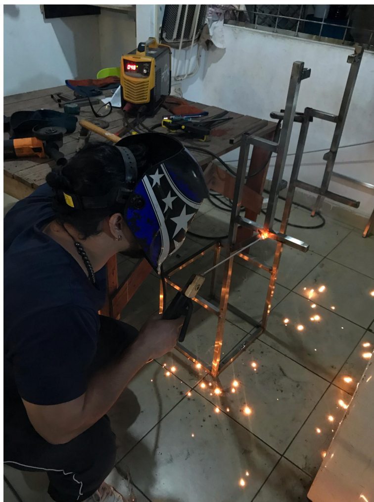
Figura 37. Soldadura de base. Fuente: Los Autores
