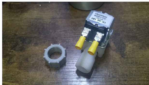
Figura 21. Montaje de electroválvula y conector. Fuente: Autores
