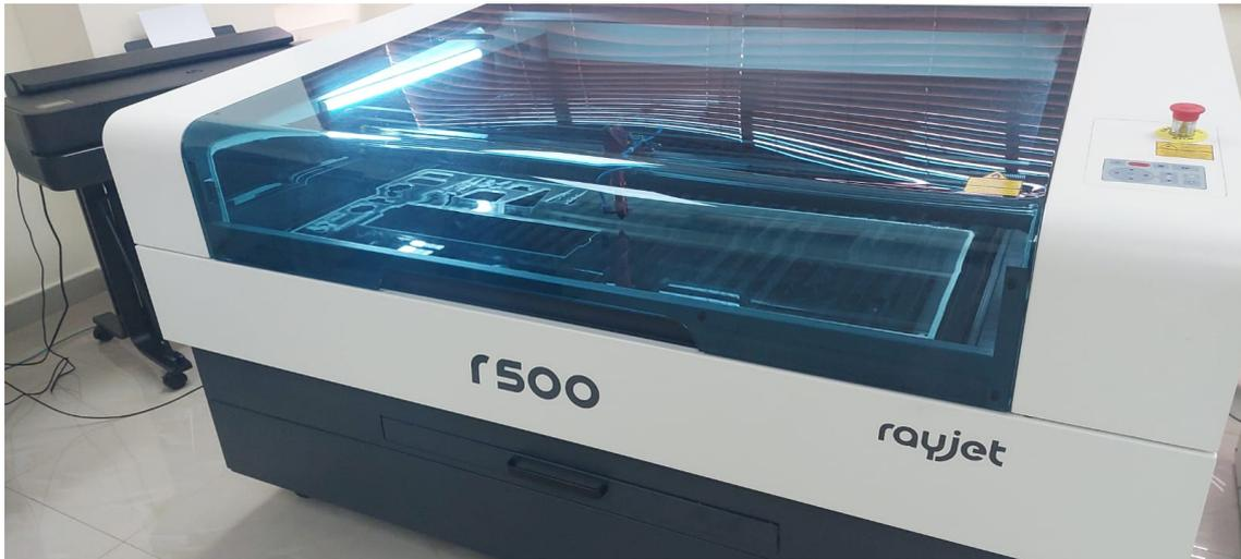
Figura 75. Máquina de Corte láser para las piezas en madera mdf, por B. Aviles y J. González
