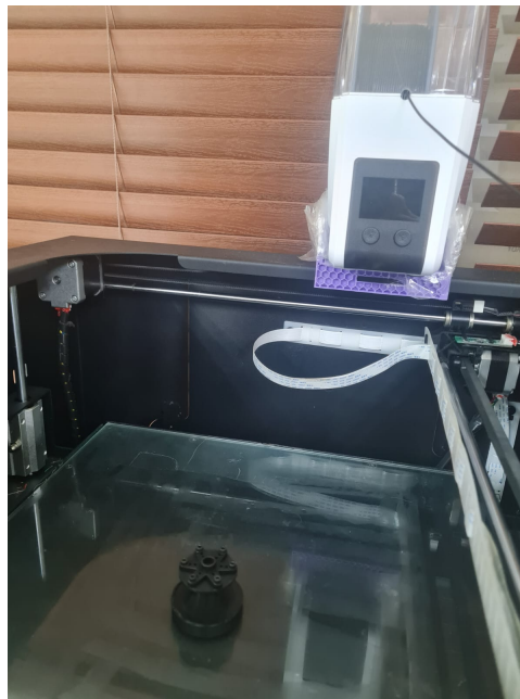
Figura 41. Impresión 3D de Disco para Sujetar. Fuente: Autores.
