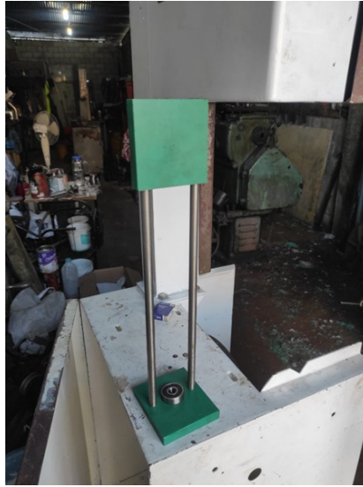
Figura 59. Acoplamiento de ejes, rodamientos y tornillo sin fin
