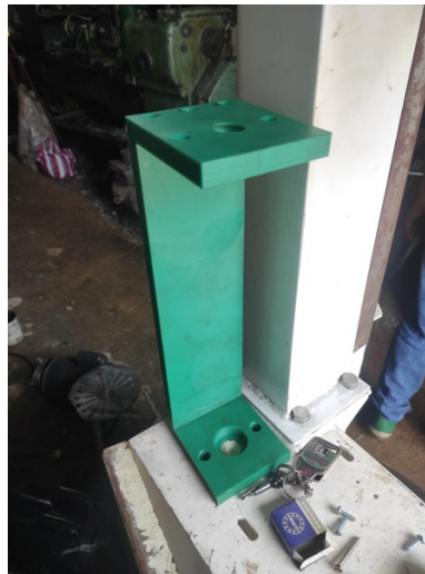
Figura 58. Perforaciones para acoplamiento de ejes, rodamientos, tornillo sin fin
