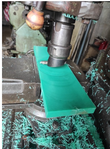
Figura 56. Corte de placas para fabricación de estructura de fresadora.
