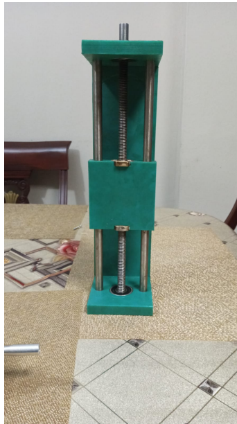
Figura 60. Pre - montaje completo del prototipo de fresadora
