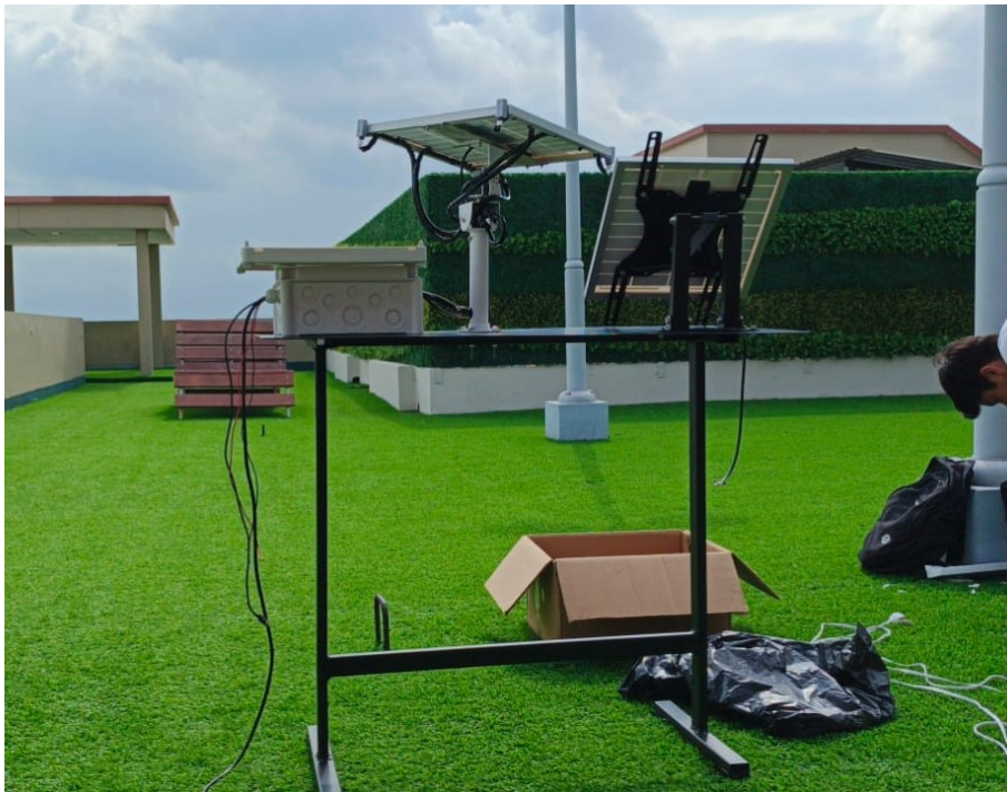
Figura 63: Instalación del seguidor solar y panel fijo sobre la mesa de pruebas para recopilación de datos. Fuente: Autores.
