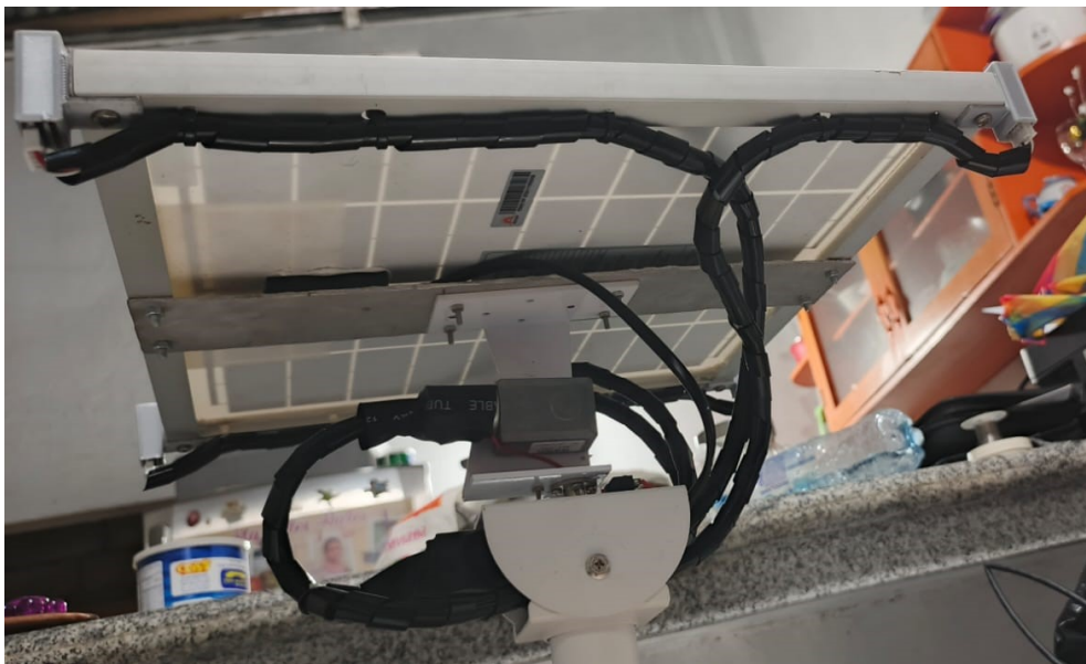
Figura 59: Cableado de LDRS, ordenados y aislados. Fuente: Autores.
