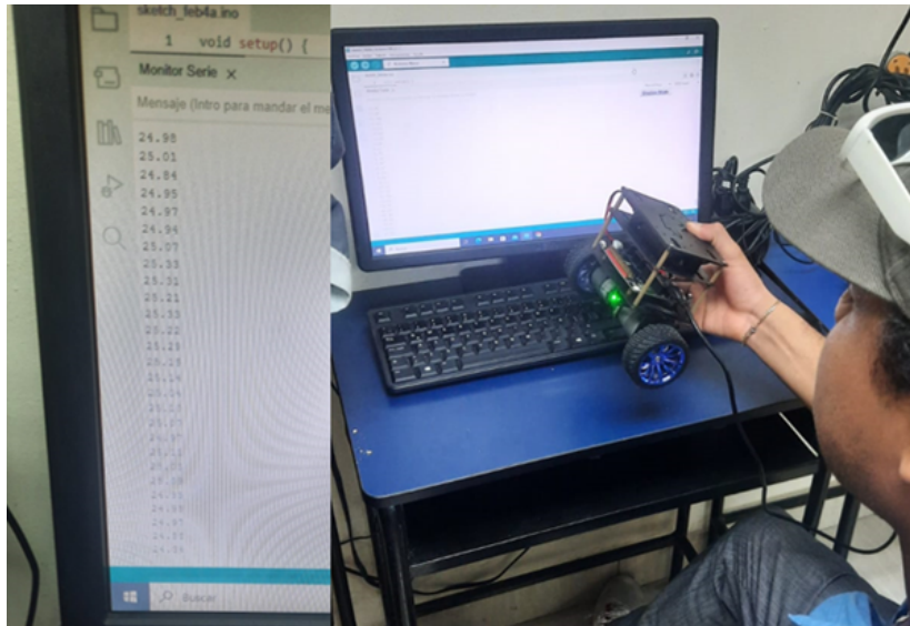
Figura 46. Lectura del MPU6050 del prototipo 1
