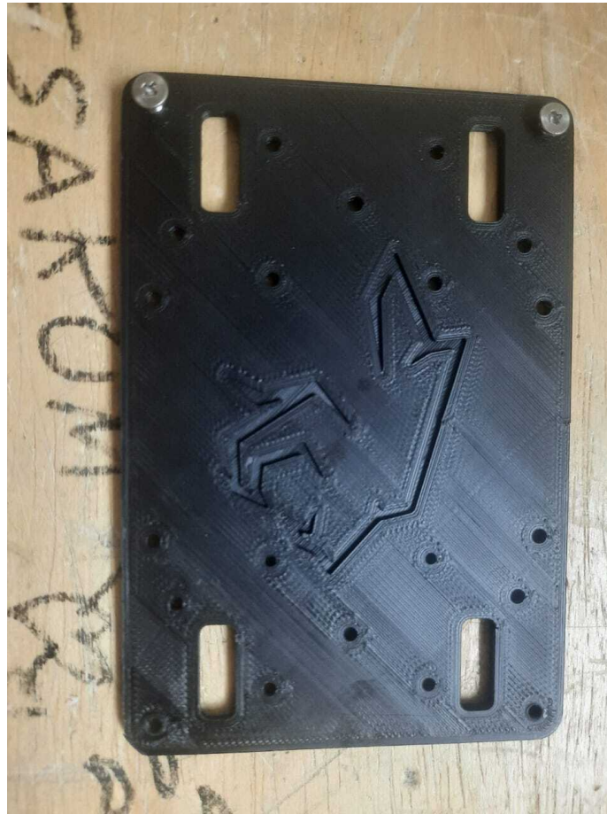
Figura 43. Base del robot pendulo invertido impresa por Autores
