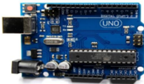
Figura 10. Placa de arduino UNO obtenida de [30]
