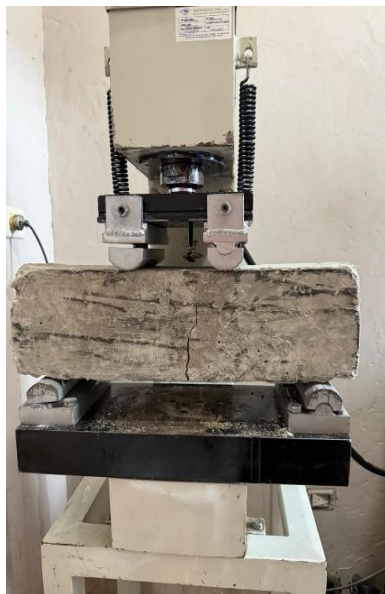
Figura 30: Viga de concreto sometida a ensayo de flexión
