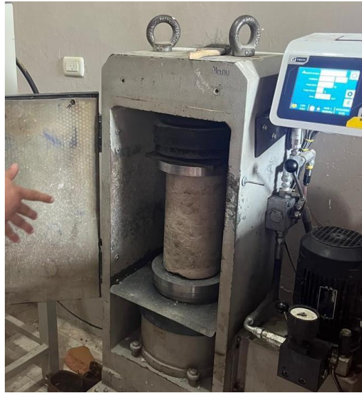
Figura 11: Rotura de Cilindro
