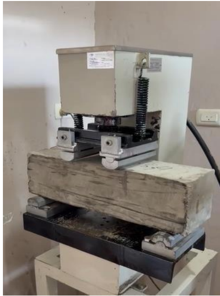
Figura 31: Viga de concreto con fibra de vidrio en capas sometida a ensayo de flexión
