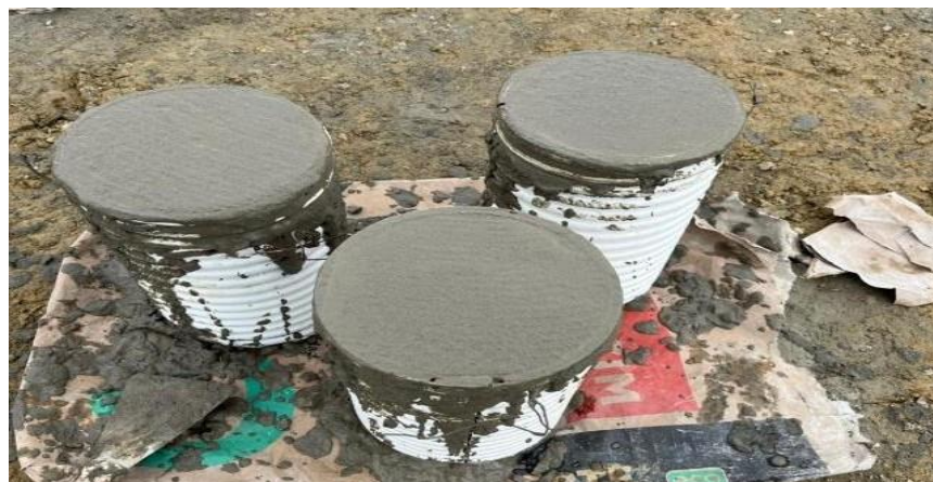
Figura 10: Cilindros con Hormigón reforzado con Fibra de Vidrio
