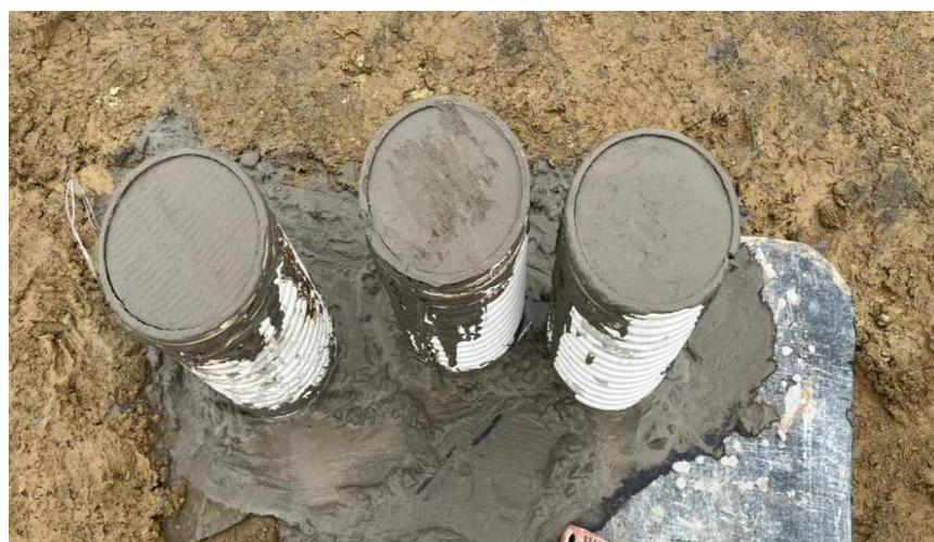
Figura 9: Cilindros con Hormigón Convencional
