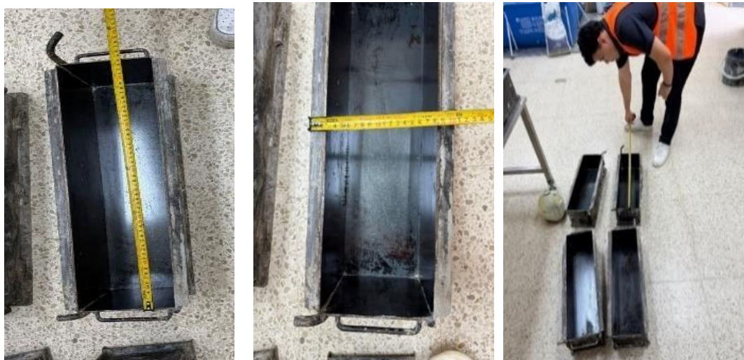
Figura 13: Medición del molde de las viguetas (ASTM-C31)
