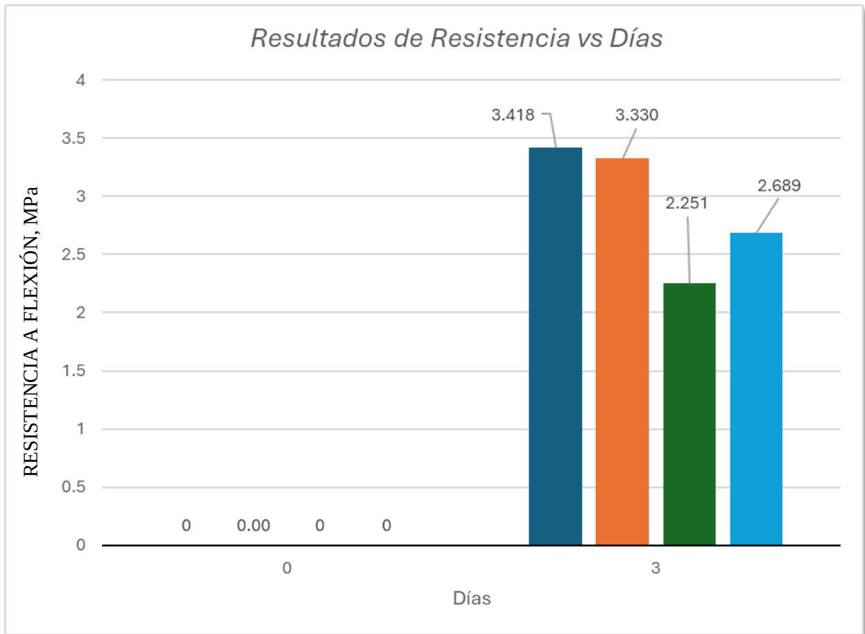
Figura 21: Ensayo a Flexión a los 3 días (Hormigón Convencional, Hormigón con 1.5%FV, 3%FV,4.5%FV(MPa))
