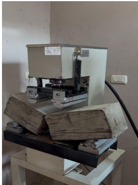
Figura 32: Viga de concreto con baja dosificación de fibra de vidrio sometida a ensayo de flexión
